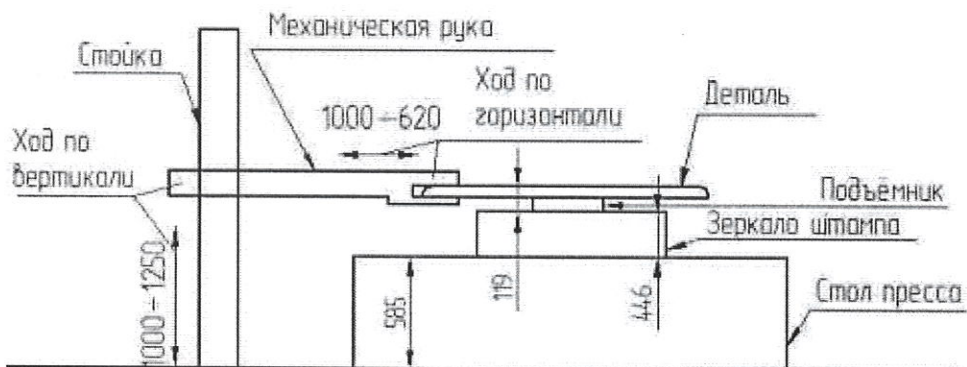
Схема съема и установки детали
